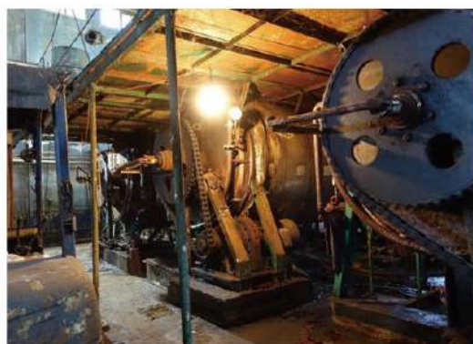
原動機、傳動帶或轉軸應裝設護罩、護圍或護網等設備
