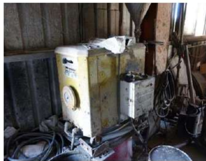
交流電焊機應設自動電擊防止裝置
